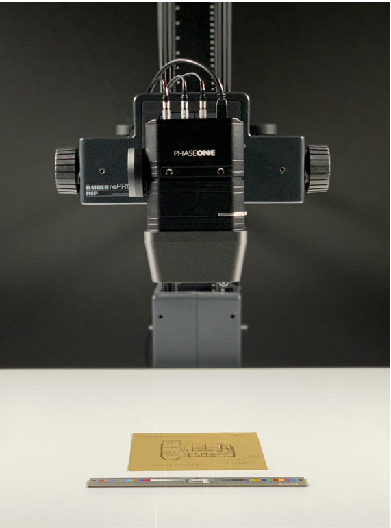
// Eit av fleire kameraoppsett ved produksjonen til IKAMR. Phase One iXC 100mpx kamerasystem, referansekort/«target» frå Image Science Associates (ISA) object level target og original frå Fürst-arkivet (Fürst og Backer Fürst Arkitektkontor) Arkiveigar VITI – Jugendstilsenteret. Foto: Ottar A.B Anderson / IKAMR //
